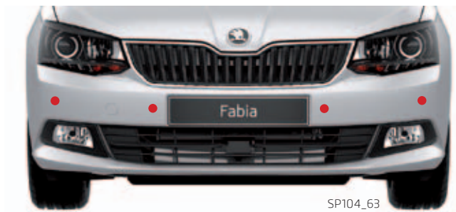
Platzierung der PDC-Sensoren in der Frontstoßstange
